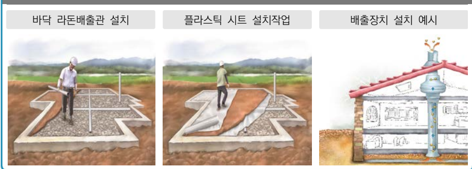
신축 주택 토양라돈 배출장치 설치 예시
