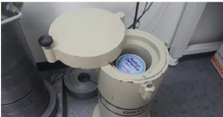
3 감마질량분석기를 이용한 감마선 측정
